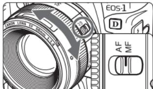
Ajuste o selector do modo de focagem da objectiva para <MF> e rode o anel de focagem da objectiva para focar.
