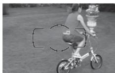
**• AF com área automática:** a câmera automaticamente detecta o assunto e seleciona o ponto de foco. Se uma lente de tipo G, E ou D é usada ( 320), a câmera pode distinguir assuntos humanos do fundo para uma melhor detecção de assunto. Os pontos de foco ativos são brevemente destacados depois de a câmera focar. Em modo **AF-C**, o ponto de foco principal permanece destacado depois de os outros pontos de foco desligarem.
