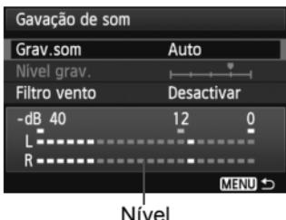
Geralmente, o microfone incorporado grava som mono. Se ligar um microfone externo equipado com uma minificha estéreo (3,5 mm diâm.) ao terminal IN de microfone externo da câmara, é possível gravar som estéreo (p.18). Se houver um microfone externo ligado, a gravação de som passa automaticamente a ser efectuada pelo microfone externo.
