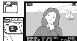
Para remover a protecção da fotografia de forma a permitir a respectiva eliminação, pressione o botão
