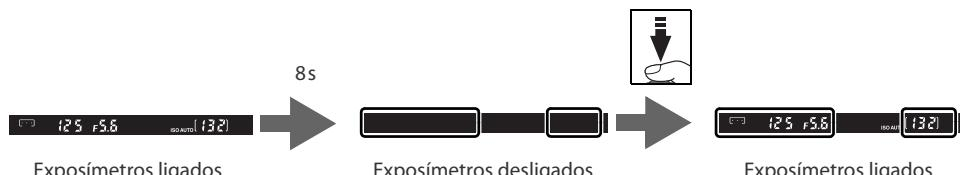
O período de tempo antes dos exposímetros se desligarem automaticamente pode ser ajustado com a Definição personalizada 15 (**Temp. deslig. auto.**;
