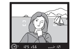
**4.2** Pressione suavemente o botão de disparo do obturador completamente para disparar o obturador e gravar a fotografia. A luz de acesso junto à tampa da ranhura do cartão de memória acende-se. *Não ejecte o cartão de memória nem retire nem desligue a fonte de alimentação até a luz se apagar e a gravação estar concluída.*
