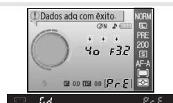
Se for apresentado o aviso mostrado à direita, a câmara não conseguiu medir o balanço de brancos. Regresse ao Passo 2 e meça o balanço de brancos novamente.
