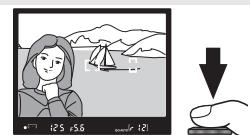
O botão de disparo do obturador não pode ser utilizado para bloquear a focagem no modo ( 19), no modo de disparo contínuo ( 32) ou na focagem automática de servo contínuo ( 23). Utilize o botão AE-L/AF-L para bloquear a focagem. Com outras definições, a focagem permanece bloqueada entre disparos se o botão de disparo do obturador for pressionado ligeiramente.
