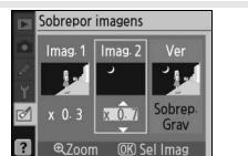
**7** Pressione o multiselecteur para a esquerda ou para a direita para marcar a coluna **Ver**. Pressione o multiselecteur para cima ou para baixo para marcar uma das opções seguintes e pressione **OK**.
