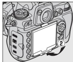
Para remover a tampa, segure a câmara com firmeza e puxe a parte inferior da tampa para fora com cuidado, conforme ilustrado à direita.
