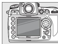
**Focagem manual** (modo de focagem M, pág. 81): Foque utilizando o anel de focagem da objectiva. O ponto de focagem para a telemetria electrónica pode ser seleccionado utilizando o multisselector.
